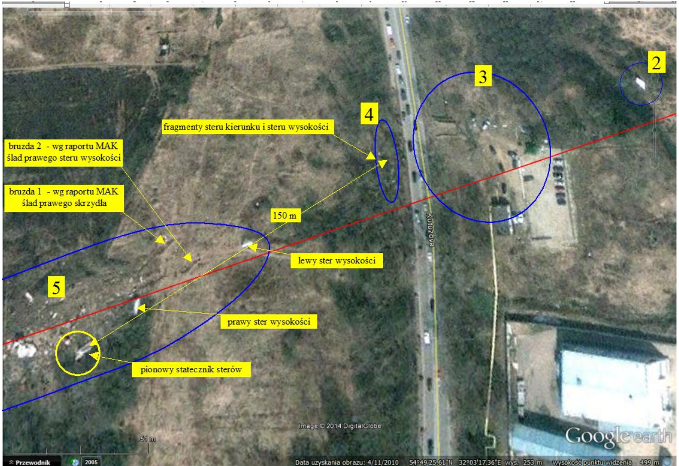
Rys. 9. Strefy rozłożenia szczątków samolotu - strefa 3 koło autokomisu ([7]).
