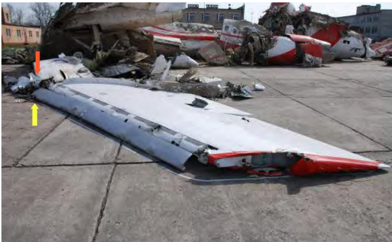
Rys. 31. Oderwana końcówka lewego skrzydła. skrzydło z zaznaczonymi elementami wg opisu. Opr. własne na podstawie [10].
