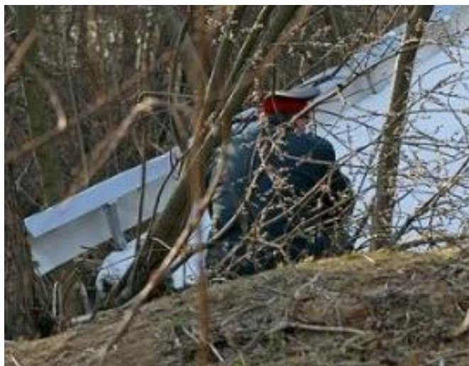
Rys. 20. Krawędź trzeciej sekcji slotu wystająca poza urwaną końcówkę skrzydła. (zdjęcie z Internetu)
