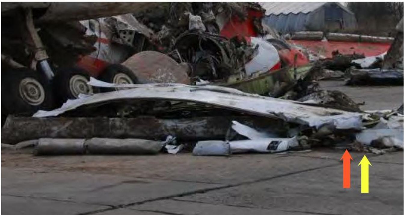
Rys. 30. Zniszczone lewe skrzydło z zaznaczonymi elementami wg opisu. Opr. własne na podstawie [10].
