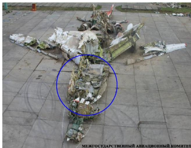
Rys. 1. Kadłub wraku, który według MAK powstał w wyniku zgniatania wynikającego z działania sił zewnętrznych - uderzenia w ziemię.
